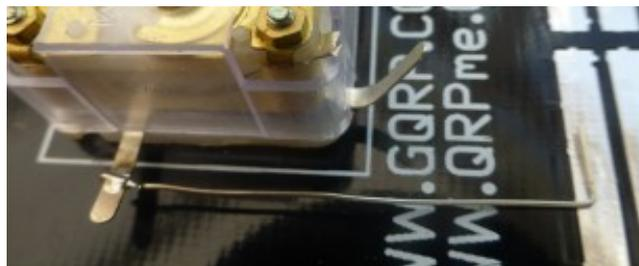
A continuación, use un trozo corto de hilo CED y conecte las dos lengüetas de abajo del condensador LOAD entre sí y al terminal inferior de S2. Después conecte un condensador de 470 pF entre el terminal superior de S2 y la lengüeta lateral del condensador LOAD. Para estas conexiones del condensador, haga un pequeño lazo en el extremo de la patilla y apriételo suavemente para fijarlo a la lengüeta del condensador variable antes de soldarlo.
