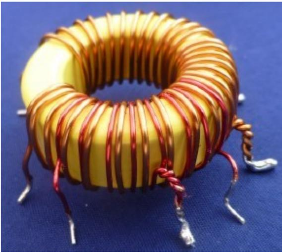
Por último, cuando tenga todos las tomas preparadas y estañadas, deberá doblarlas hacia abajo para soldarlas a la placa y mantener la bobina ligeramente separada de la placa. El bobinado de 29 espiras es el Primario y el de 8 espiras es el Secundario.
