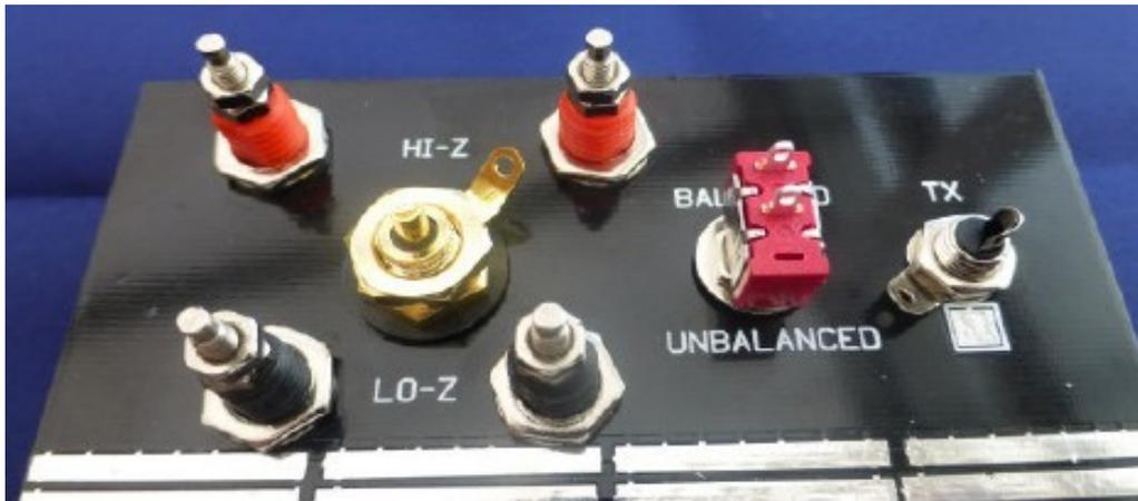
No hay nada de especial en montar estos componentes. Únicamente asegúrese de que la arandela aislante especial del conector RCA (phono) dorado está encajada perfectamente en el agujero desde el lado externo del panel. La arandela aísla el contacto exterior del conector de la placa de circuito impreso, que va conectada a masa. Necesitará doblar ligeramente la hembrilla del conector Tx para facilitar la soldadura.
